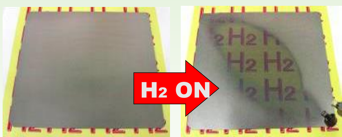
水素に反応してミラーから透明に変化
