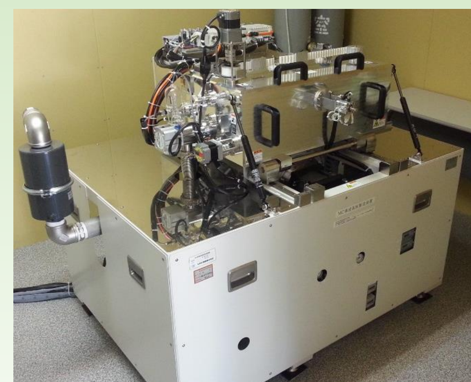
大気に曝すことなく複数ターゲットの同時・連続成膜が可能 小型で試作開発に適したスパッタ装置
