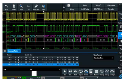
標準セグメントメモリで、より長い観測時間にわたって信号を捕捉
