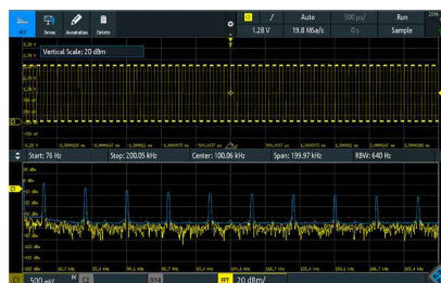
高性能な FFT 機能で最大 128 k ポイントで信号を解析
